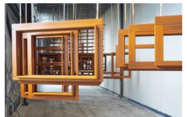
Holzrahmen und Flügel in der Trocknungsphase. BILD: VEESER
