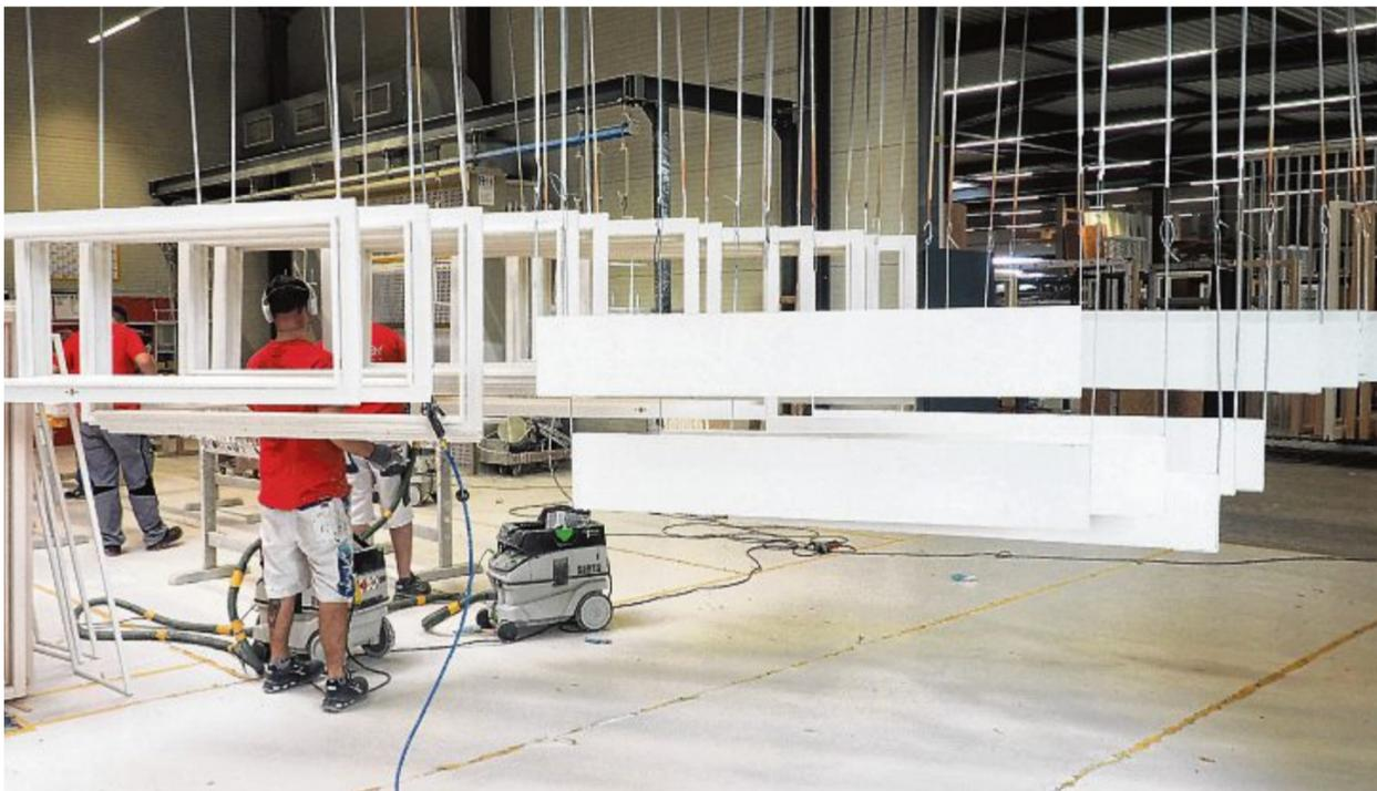
Holzrahmen und Flügel in der Trocknungsphase. BILD: VEESER
