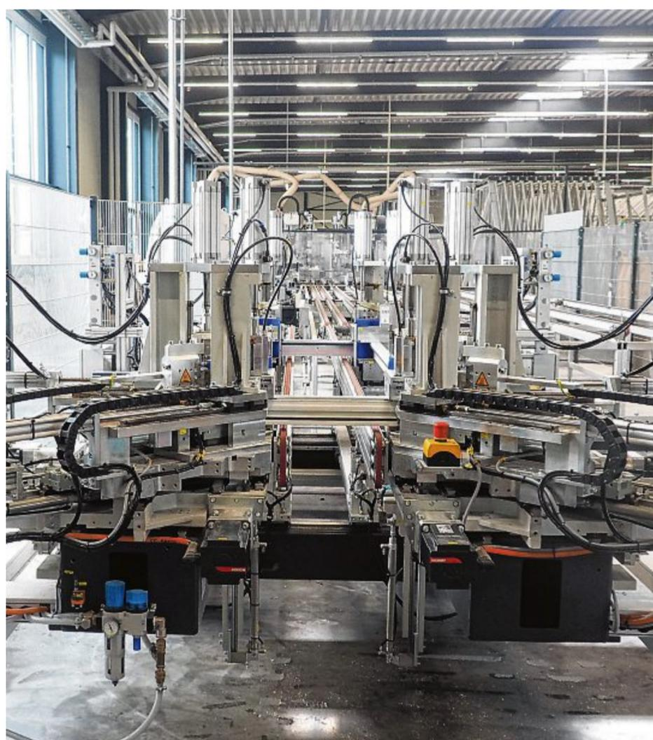
Auf dieser Maschine werden die Kunststoffrahmen verschweißt. BILD: VEESER
