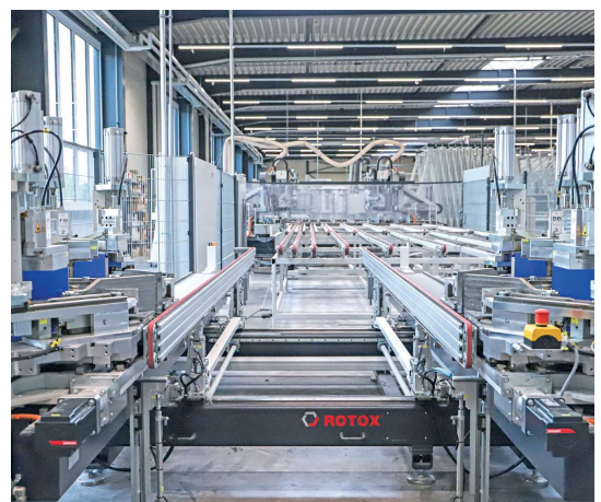
Auf der hochmodernen Produktionslinie für Kunststofffenster werden vier einzelne Profilstäbe gleichzeitig zu Flügel- und Blendrahmen verschweißt. Nach der Kühlzeit werden die Teile automatisch übernommen, verputzt und endbearbeitet.
